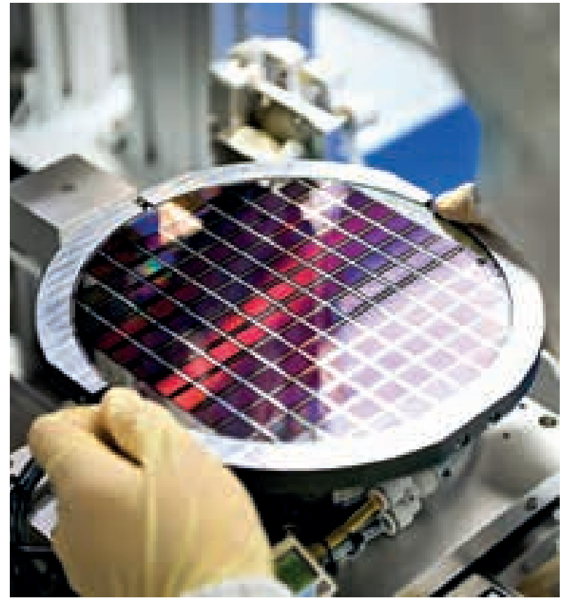
江苏昆山一家国家级专精特新“小巨人”企业内，生产人员将晶圆放入贴片机，准备进行玻璃盖板贴合作业。图/新华
