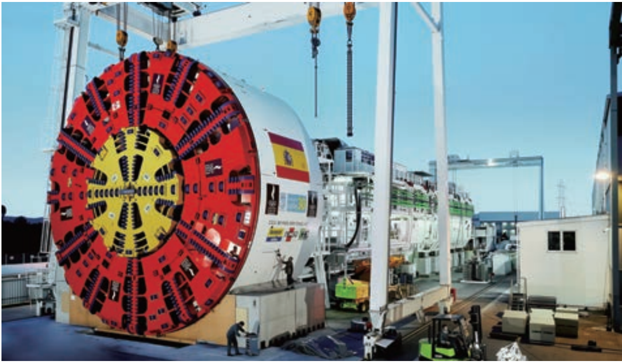
配备 Bosch Rexroth 液压组件的隧道掘进机可用于建造长距离山岭隧道(2015年)。图/博世在中国
